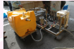
循環システムとタンクを接続
